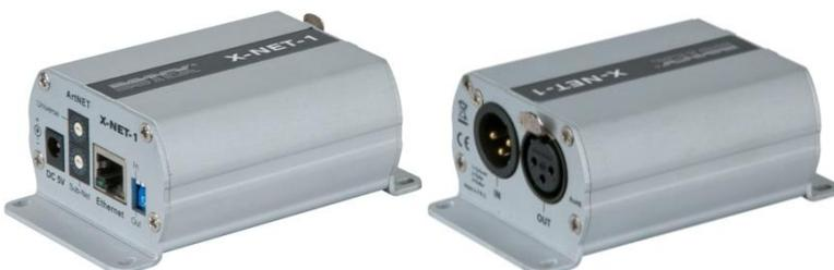
Es handelt sich dabei um einen 2-Wege-Signalwandler für DMX/Artnet-Signale. An einer Seite wird ein Cat-Kabel mit Videosignalen angeschlossen und auf der anderen Seite werden DMX-Signale an den Matrix Blinder ausgegeben.
