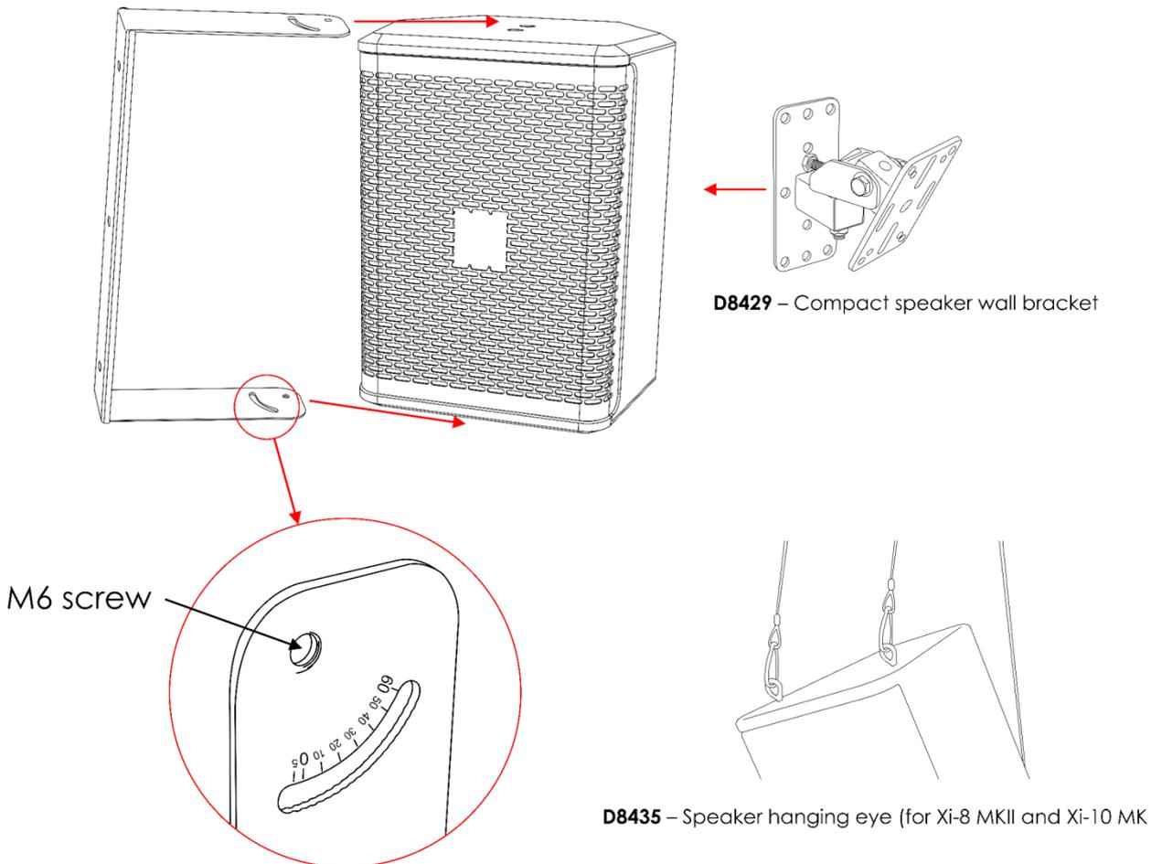
Les haut-parleurs Xi MKII peuvent être placés sur une surface au sol dégagée, ou montés sur n'importe quelle structure à l'aide de colliers de montage (**D3422HB / D3422WHB / D3423HB / D3423WHB / D3424HB / D3424WHB / D3425HB / D3425WHB**). Ils peuvent également être montés sur un mur grâce au support mural pour haut-parleur compact (**D8429**). Les modèles Xi-8 MKII et Xi-10 MKII peuvent être suspendus au plafond grâce à un œillet de fixation pour haut-parleur (**D8435**).
