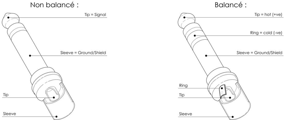
Dans le cadre de ces utilisations, l'appareil est pourvu de prises TRS et XLR 1/4" permettant de connecter facilement la plupart des appareils professionnels de sonorisation. Suivez les exemples ci-dessous pour mettre au point votre propre configuration.
